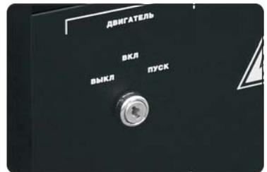
(c) Установите выключатель в положение «ВЫКЛ».
