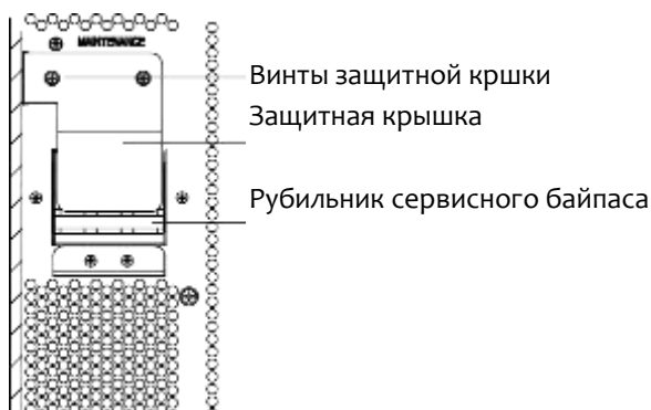
Рис. 4-2. Расположение сервисного байпаса.
